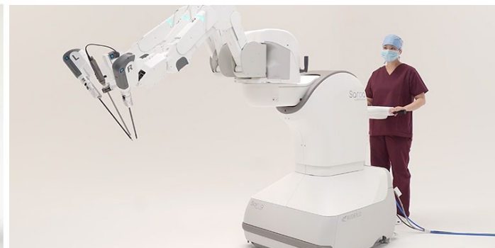
『Saroa』 触覚を再現した低侵襲外科手術用支援ロボット 令和5年5月上市
