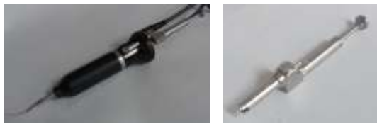
図 3-7-2 開発した改良型ハンドセット全景（左）と泡出し用エア注入ユニット（右）
