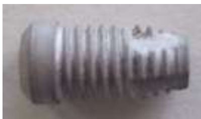
図 2. MIM で製作したハイブリッドチタンインプラント体
