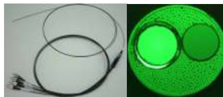
図 3 PDT 用 8 の字型光ファイバスコープと先端部
