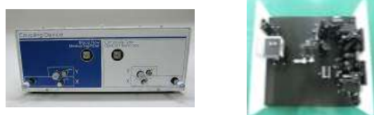
図 4 カップリング装置(正面)及び内部
