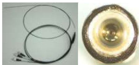
図 2 開発した複合型光ファイバスコープ(左)と焼灼用ファイバの先端部(右)
