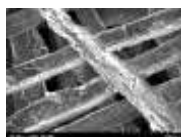
SPS による焼結の際、食塩スペースホルダーにて多孔質構造が形成された純チタン薄板(左: 厚さ 0.5mm)および走査型電子顕微鏡(SEM)像(右)
