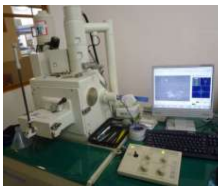
写真 2.2.2-11 SEM 走査電子顕微鏡 JSM-5900LV/JED-2200 JEOL 製
