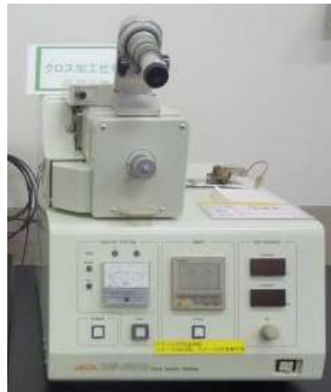
写真 2.2.2-12 精密断面試料作製装置 SM-09010 JEOL 製
