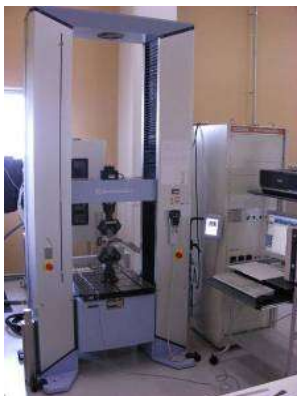
写真 2.2.2-1 オートグラフ AG-X(100kN)
