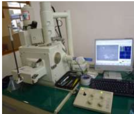
写真 2.2.2-5 SEM 走査電子顕微鏡 JSM-5900LV/JED-2200 JEOL 製
