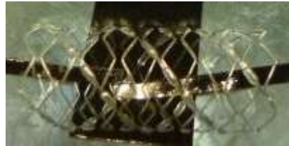
写真 2.3-8 金蒸着させたステント
