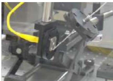
図4 水中におけるプローブからの射出光の評価の様子
