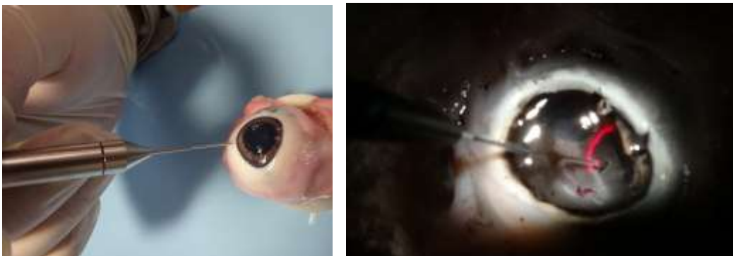
図14 豚眼計測実験(左: 手術使用の様子を擬似的に再現、右: 網膜計測の様子)
