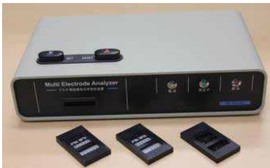
図 2-4-1. H24 年度に開発した電気化学測定装置とマルチ電極.
