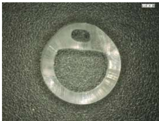
2 ルーメンチューブ試作品断面図
