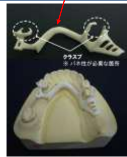
ナノジルコニア材料を用いて 新開発のCAM装置で 義歯フレームを製作
