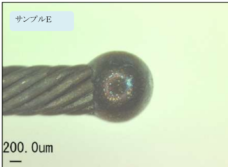
図2-5 ケーブル先端の解け止め溶接品
