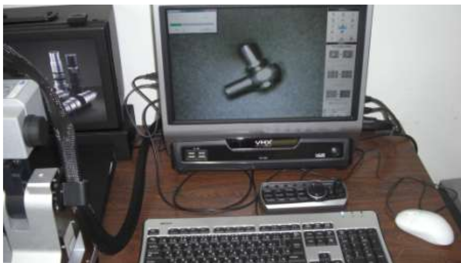
図2-4 高解像度顕微鏡使用例(クリンプ表面の観察)
