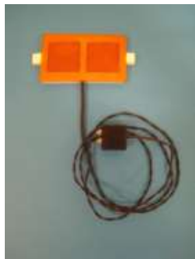
30×60 PVDF による振動子の例 (厚さ 1mm 以下)
