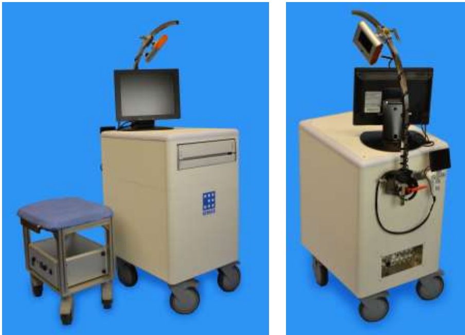
図 1 5 IEMAS™ 完成外観（上図左は映像処理装置を収納した検査者用椅子と IEMAS™ コンソールを正面から撮影。上図右はタスクディスプレイ、スタンド、検査者用タスクコントローラを一括して収納された背面から撮影。）
