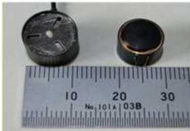
図6 左：φ12（昨年度試作品）、右：φ10（本年度試作品：タイプB）
