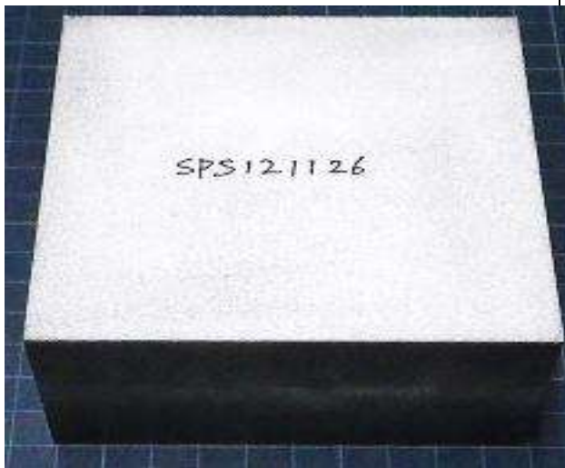
フッ化マグネシウム焼結体試作品 (100mm×100mm×50mm)
