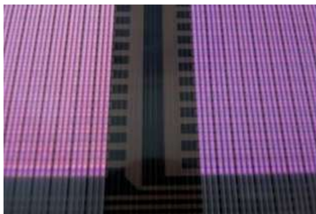
図3-2 発光拡大： 標準条件Xe4% (左)、放電ガス最適化Xe7% (右)
