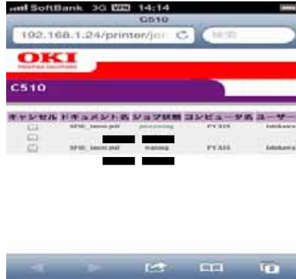
図 10 携帯端末から L2TP/IPsec によるアクセス例
