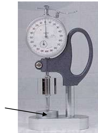
図7 定圧厚さ測定器 矢印部分に水晶体を固定し、 定圧下で厚みを測定する。
