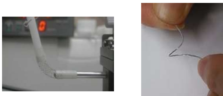
図2-8. ステントの曲げ剛性測定の様子（左）ステントをマイクロシースに実装した状態で屈曲させた場合の様子を表した画像（右）。
