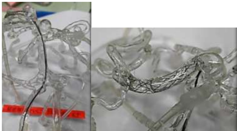
図 2-10. 脳血管実形状モデル内でマイクロカテーテルによるステント輸送を実施した際の様子 (左) 屈曲した血管モデル内に留置されたステント (右)
