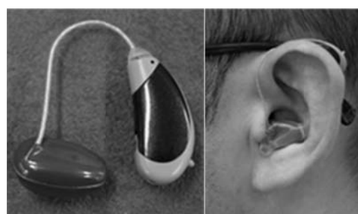
左：汎用形状(試作)振動子部と耳かけ型補聴器本体 右：その装着写真(耳を塞がない装着)
