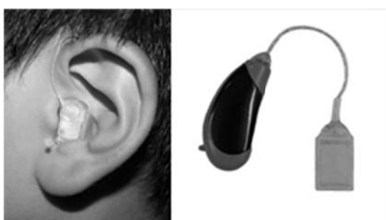
左：外耳道閉鎖症に装着した軟骨伝導補聴器 右：耳かけ型補聴器本体と振動子
