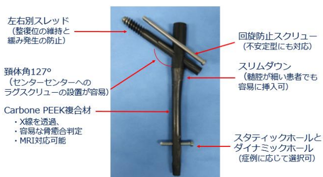
高機能複合材製大腿用ガンマー型ネイルシステム
