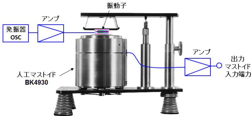
人工マストイドによる力出力測定
